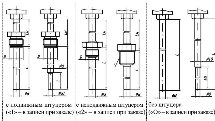
Стандартные длины  $L$ ,  $l$  и диаметры  $d$ ,  $d_1$  монтажных (погружаемых) частей защитного корпуса, типы и резьбы  $D$  установочных штуцеров приведены в таблице 5.
