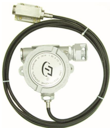
Общий вид ППТП с защитным корпусом типа «К2», с головками типа Г6», «Г6/1», «Г6/2», «Г6/У», «Г6/1/У», «Г6/2/У» с соединительным кабелем с внешней оболочкой из нержавеющей трубы и металлорукава в полихлорвиниловой изоляции МРПИИ 10
