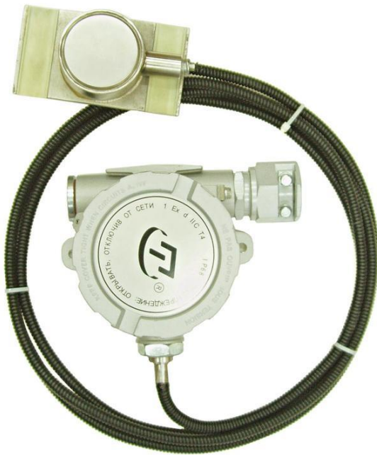
Общий вид ТС с защитным корпусом типа «К1», с головкой типа «Г6», с соединительным кабелем с внешней оболочкой из нержавеющей трубы и металлорукава с полихлорвиниловой изоляцией МРПИ 10
