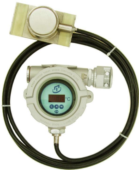
Общий вид ТС с защитным корпусом типа «К1», с головкой типа «Г7», с соединительным кабелем с внешней оболочкой из нержавеющей трубы и металлорукава с полихлорвиниловой изоляцией МРПИ
