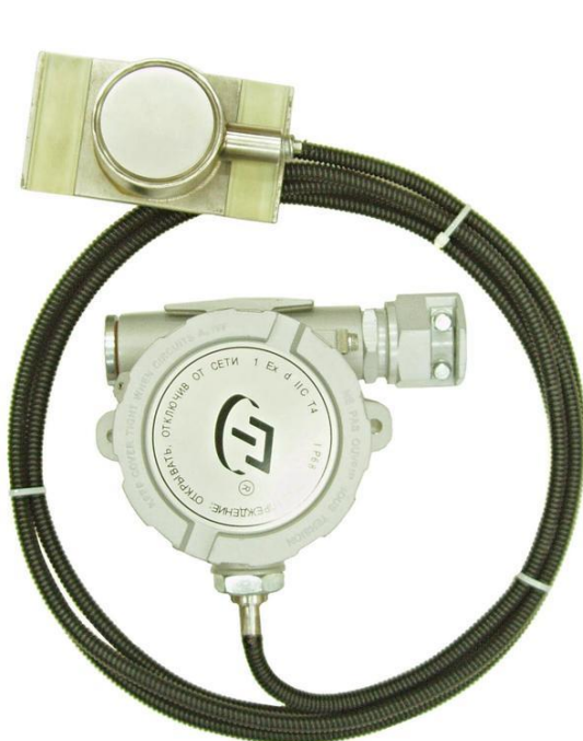
Общий вид ТС с защитным корпусом типа «К1», с головкой типа «Г6», с соединительным кабелем с внешней оболочкой из нержавеющей трубы и металлорукава с полихлорвиниловой изоляцией МРПИ 10
