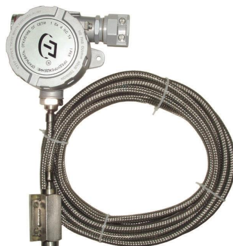
Общий вид ППТП с защитным корпусом типа «К2», с головками типов Г6», «Г6/1», «Г6/2», «Г6/У», «Г6/1/У», «Г6/2/У» с соединительным кабелем с внешней оболочкой из гибкого рукава (сильфона) в оплетке
