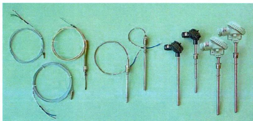
Рисунок 6 – Преобразователи погружаемые общепромышленные ТХА 002-Оп, ТХК 002-Оп и взрывозащищенные ТХА 002-Exi, ТХК 002-Exi с диаметром защитной арматуры до 10 мм включительно
